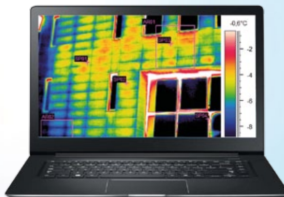
Rys. 1. Termogram ściany zewnętrznej dobrze wentylowanej [2]
